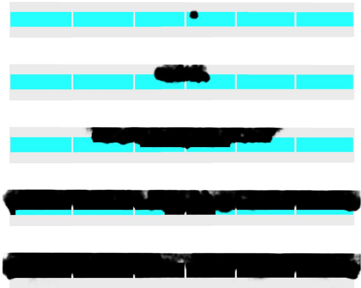
Abbildung 5.1: Versagen der Fensterscheiben im Brandraum im zeitlichen Verlauf
