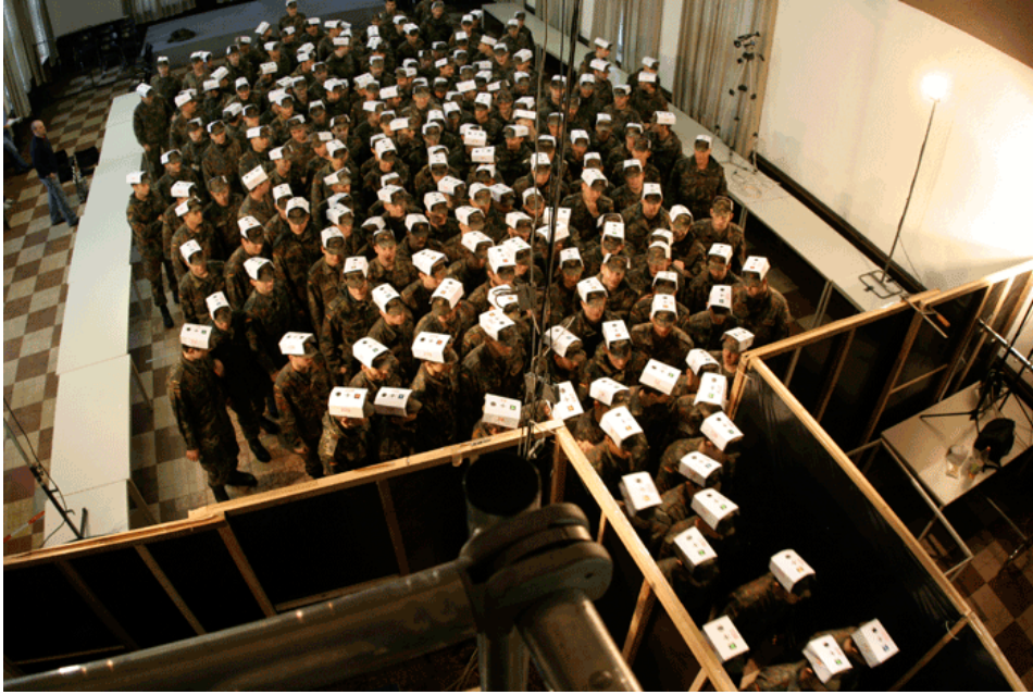
Abbildung 4.5: Versuchsablauf, Eintritt in die Engstelle
