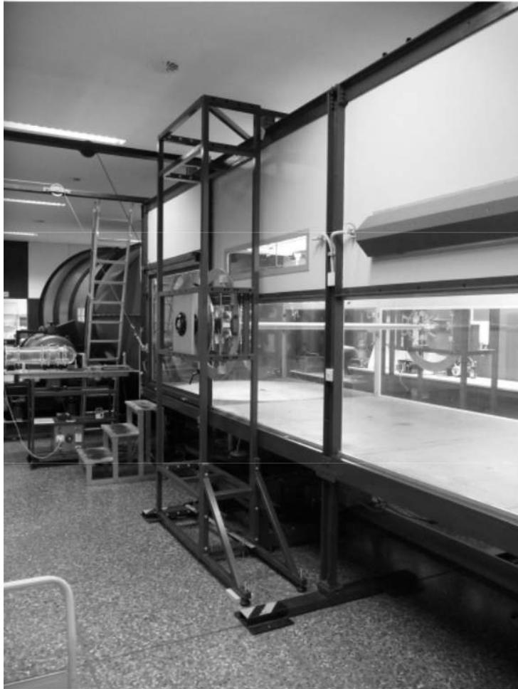
Abbildung 13.3: Versuchsstand zur Messung von aerodynamischen Kräften. Quelle: [31]
