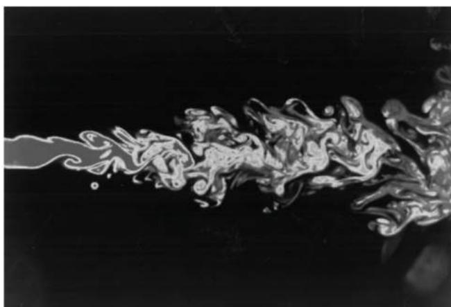
(a) Düsenstrahl im Rohr.
