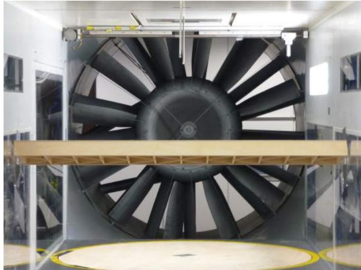
Abbildung 13.4: Modellquerschnitt der Tacoma-Narrows-Brigde. Foto: [51]/[31]
